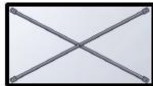
Üst Çapraz kol 110 L=1,726 m (Ø 33,7 mm) Ref. DEM 000 000 1012000 Ağırlık: 5,301 kg
